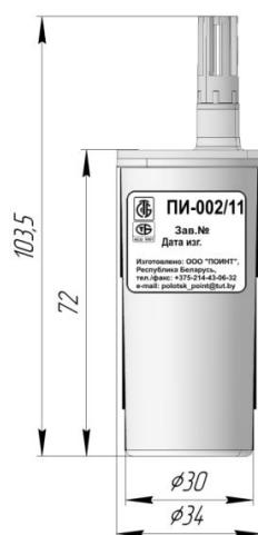
Рисунок 2.7-Прибор измерительный ПИ-002/11
