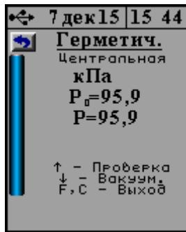
6.3.3 По достижении в камере вакуумметрического давления равного  $P_{вак} \geq 65$  кПа ( $P_{абс} \leq 35$  кПа) насос выключится. После нажатия кнопки запустится процесс проверки герметичности.
