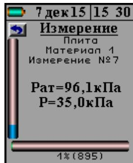
Процесс измерения можно принудительно прервать с помощью кнопки **C** или **F**.
