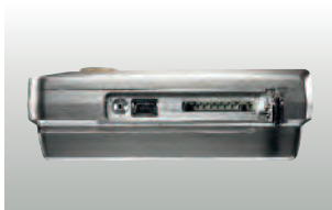
Разъем для подключения Мини-USB кабеля или SD-карты
