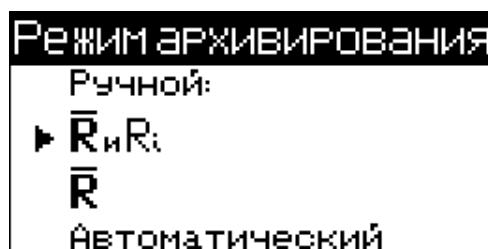
Кнопками ↓(↑) выбрать пункт  $\bar{R}_i R_i$  и нажать ВВОД. Войти в режим «Измерение Т и V», нажав несколько раз кнопку РЕЖИМ. Провести 15 измерений прочности материала каждый раз снимая и устанавливая прибор на поверхность изделия.
