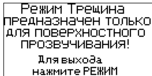
**Примечания** 1 Глубина трещины устанавливается по изменению времени распространения ультразвука методом поверхностного прозвучивания при условии, что плоскость трещинообразования перпендикулярна линии прозвучивания. Глубина трещин (рисунок 2) определяется из соотношений:
