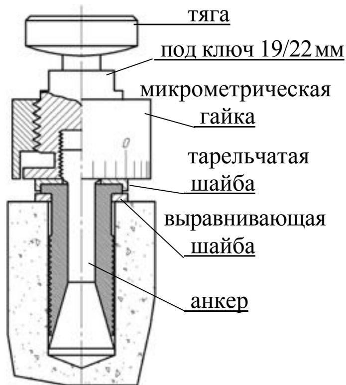
Рисунок 3.1.б – Установка анкера для остальных модификаций
