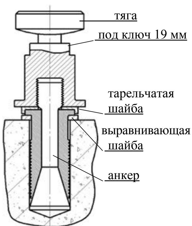
Рисунок 3.1.а – Установка анкера для модификации ПОС-50МГ4.ОД
