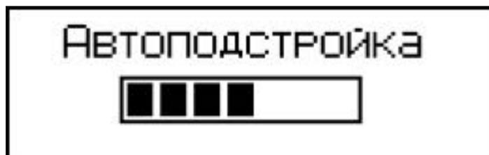
По окончании автоподстройки дисплей принимает вид, например:
