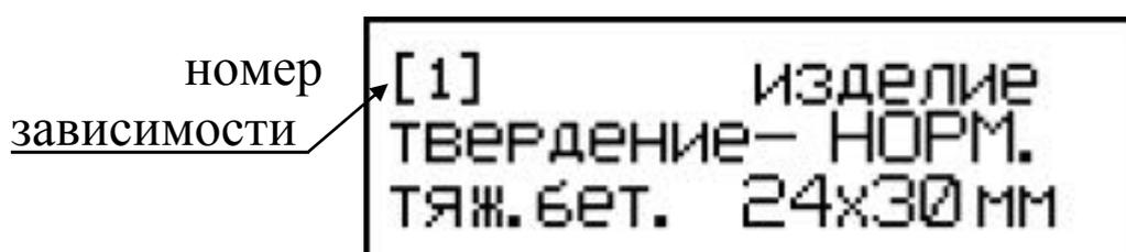
Данный режим предусматривает возможность ввода информации об испытываемом изделии, для сохранения в памяти вместе с результатом измерения и номером зависимости. Запись информации производится аналогично п. 3.2.2.7, после чего дисплей имеет вид:
