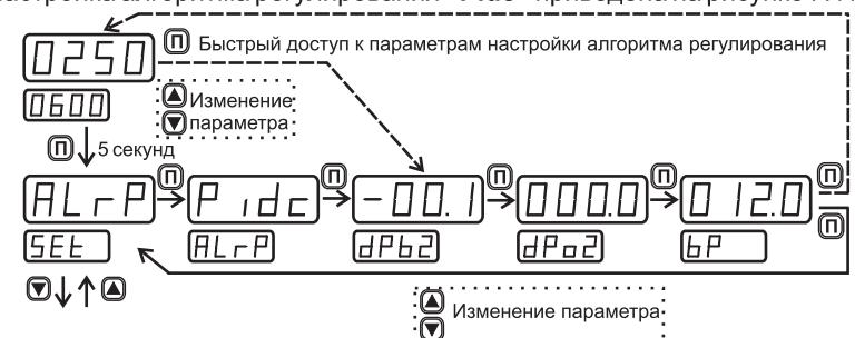
Рисунок 7.11 – Настройка алгоритма регулирования «**Pidc**»
