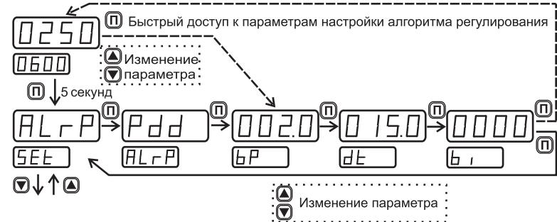
Рисунок 7.13 – Настройка алгоритма регулирования «**Pdd**»
