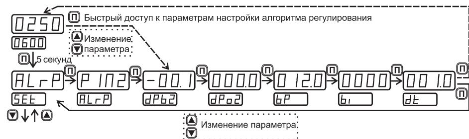
Рисунок 7.10 – Настройка алгоритма регулирования «Р1П2»
