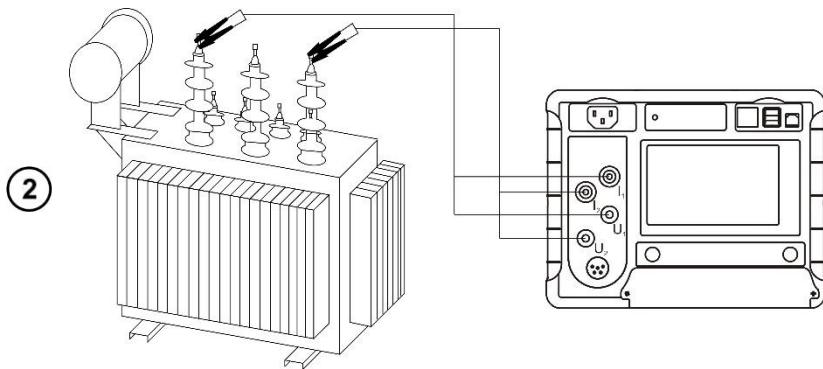
Подключите измеритель к обмотке трансформатора.
