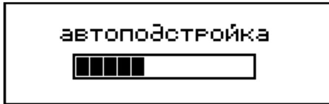
Повторный звуковой сигнал свидетельствует об окончании автоподстройки и переход в режим «Измерение», дисплей принимает вид:
