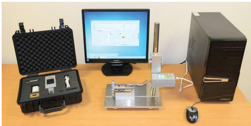
Рис. 1. Внешний вид профилометра модели 130 с управляющим компьютером
