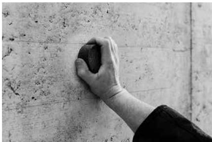
Используйте шлифовальный камень для шлифования тестовой поверхности. Выполните несколько тестовых ударов молотком для испытаний бетона на этой гладкой прочной поверхности, прежде чем выполнять какие-либо измерения, которые вы хотите оценить. Выполните проверку совпадения результатов с заданным диапазоном значений на тестовой накопительной.
