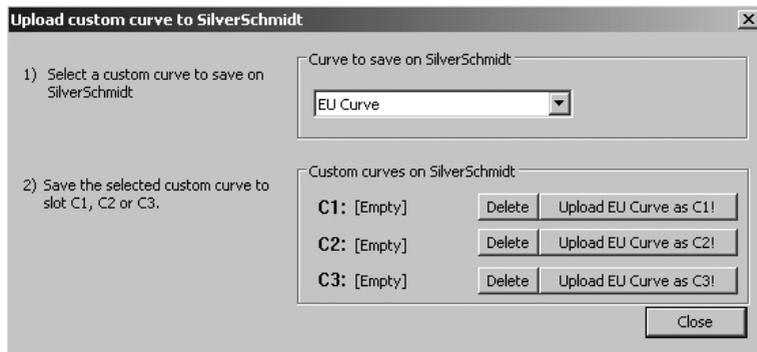
Прибор SilverSchmidt позволяет загружать одновременно до 3 пользовательских кривых. Выберите место нахождения кривой (C1, C2 или C3) и загрузите ее. Отображается предупреждающее диалоговое окно. Щелкните "Да", чтобы завершить действие.
