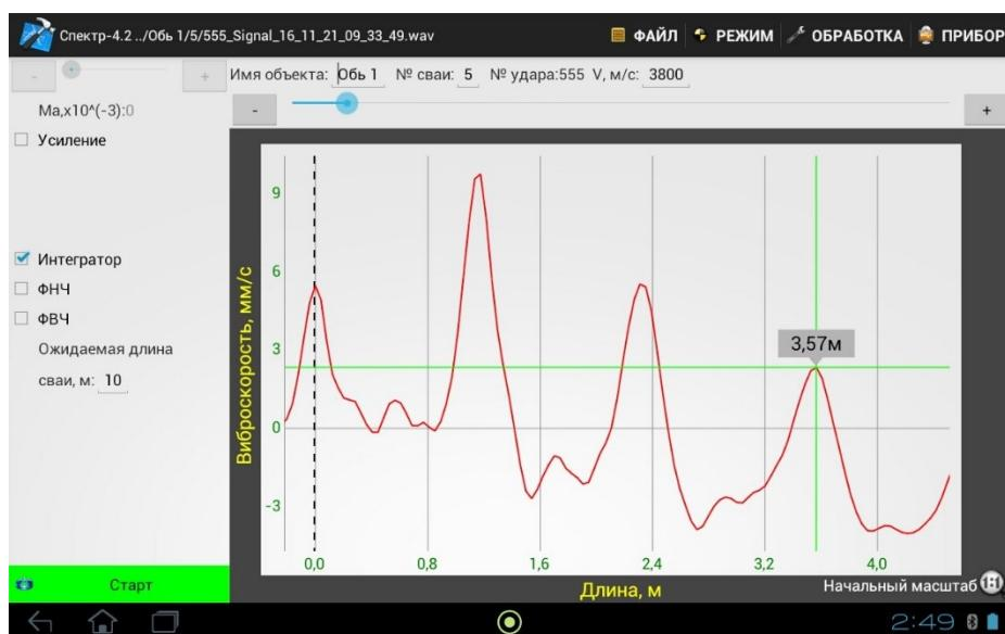
Рисунок 6.3 - Определение длины сваи
