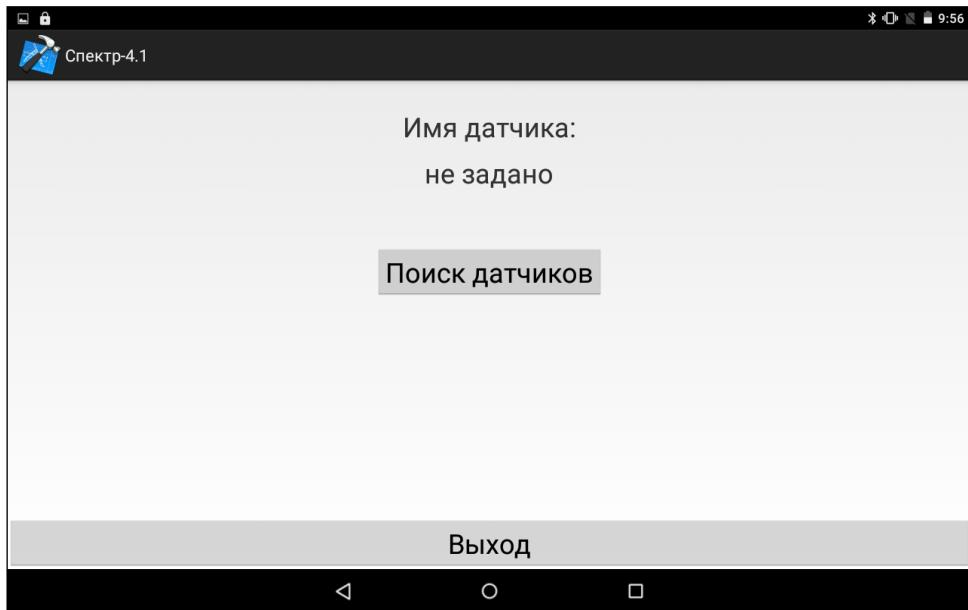
7 По завершении процесса поиска имя датчика появится вверху экрана и в списке обнаруженных датчиков. Нажать «Выход».
