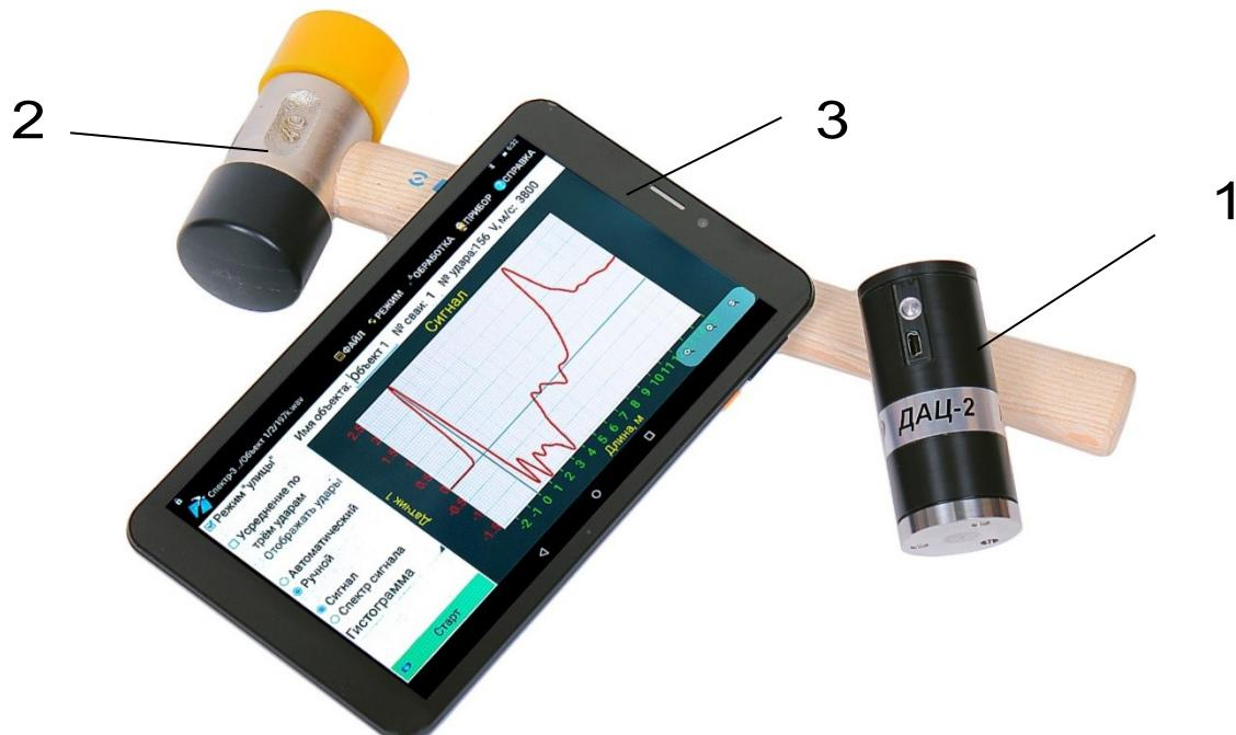
Рисунок 3.1 - Общий вид прибора Спектр-4.1.
