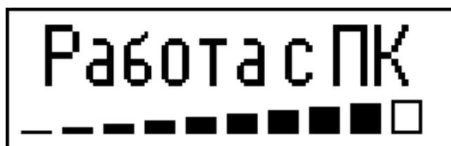
Одновременно с работой в режиме «ПК», производится подзарядка аккумуляторной батареи прибора, процесс заряда индицируется в нижней строке дисплея.
