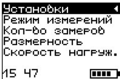
Пункт меню **Режим измерений** предназначен для выбора ручного или автоматического режимов выполнения измерений.
