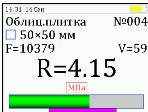
6.6.1.3 Произвести нагружение пресса до контрольного усилия или до отрыва пластины.
