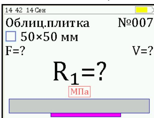
Начать равномерное вращение рукоятки привода по часовой стрелке - при достижении порогового усилия нагрузки дисплей перейдет в режим индикации процесса нагружения.
