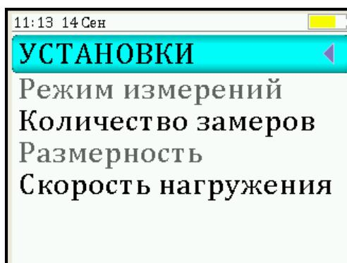
Пункт подменю «**Режим измерений**» предназначен для выбора ручного или автоматического режимов выполнения измерений.
