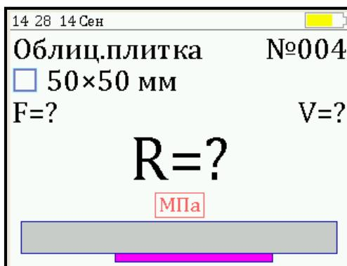
6.6.1.2 Повторно нажать кнопку
