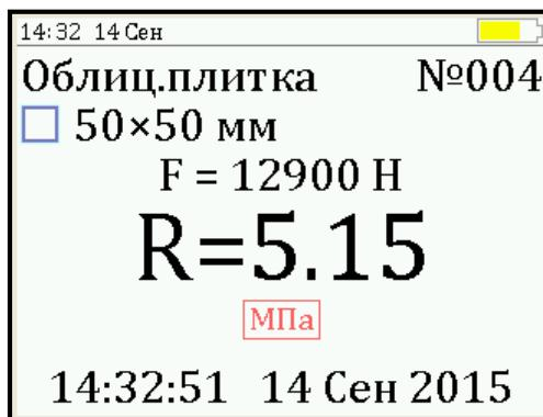
6.6.1.5 Если для оценки прочности требуется выполнить более одного измерения, то следует установить количество замеров в серии через одноименный пункт меню и выполнить серию измерений; при этом на дисплее можно просматривать результаты всех стадий измерений.
