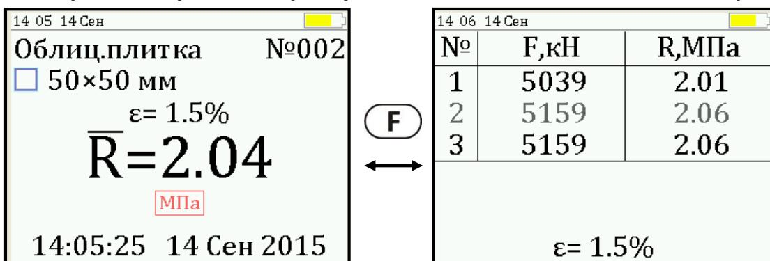
6.6.1.6 Для досрочного получения средней прочности  $\bar{R}$  (при неполной серии) следует последовательно нажать и удерживать кнопки **(S)** и **(M)**.
