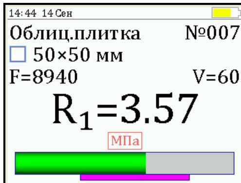
Подбором темпа вращения рукояти добиться требуемой скорости нагружения в заданных сиреневым полем пределах (200 – 300 Н/сек) и довести нагружение пресса до контрольного значения усилия (прочности) или до отрыва пластины.
