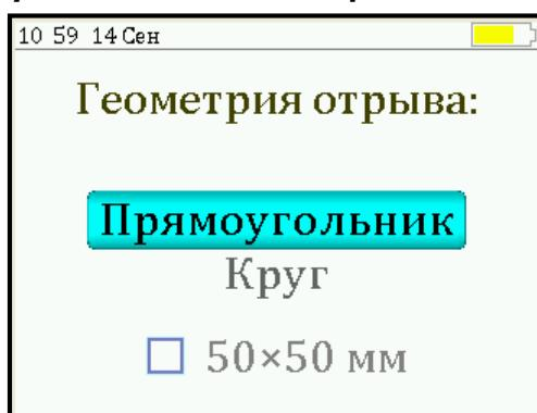
При выборе одного из двух пунктов меню и нажатии кнопки **F** на дисплее отобразится подменю установки линейных размеров площади отрыва, которые изменяются с дискретностью в один миллиметр.
