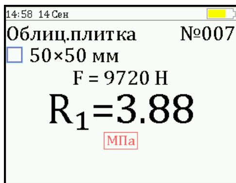
Если нагружение производилось до контрольного усилия, то результат появится после снятия нагрузки.
