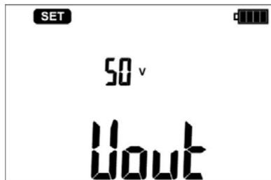
Клавишей  $U_n$  установите измерительное напряжение 25В или 50В. Через 5 с прибор готов к измерениям.
