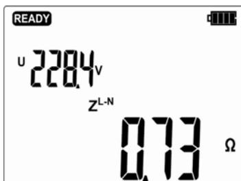
Главный результат измерения параметров петли короткого замыкания: полное сопротивление  $Z_s$  или ожидаемый ток короткого замыкания  $I_k$ .
