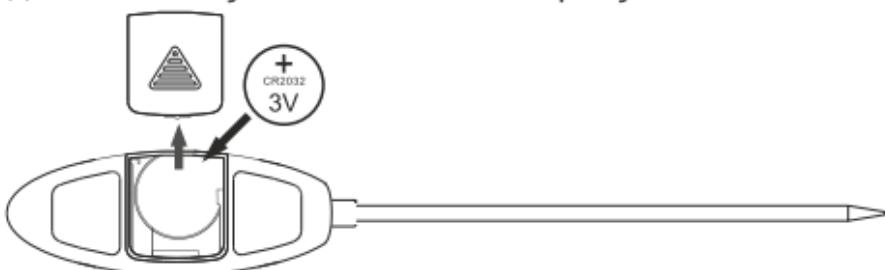
Если после включения питания напряжение батарейки ниже 2,5 В, на ЖК-дисплее отобразится значок недостаточного заряда. Во избежание неточных измерений, следует, заменить элементы питания.
