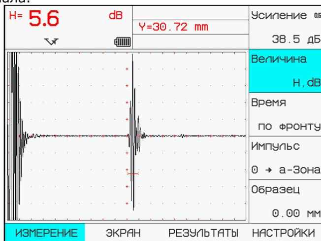
Рис. 8. Изображение донного эхо импульса в виде радиосигнала
