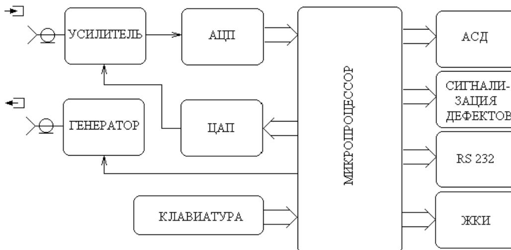
Рис. 1. Блок-схема дефектоскопа
