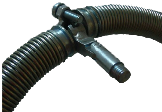
Рис. 22. Подготовленный к проведению контроля пружинный электрод
