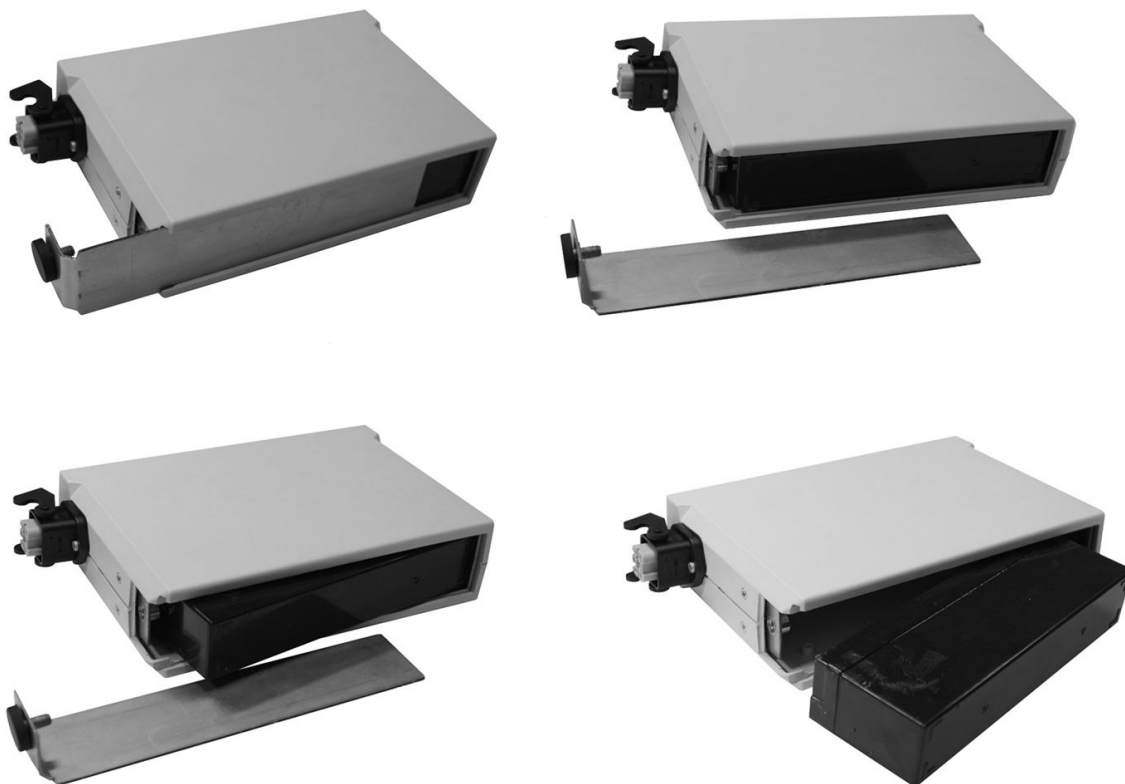
Рис. 30. Последовательность действий при замене аккумулятора
