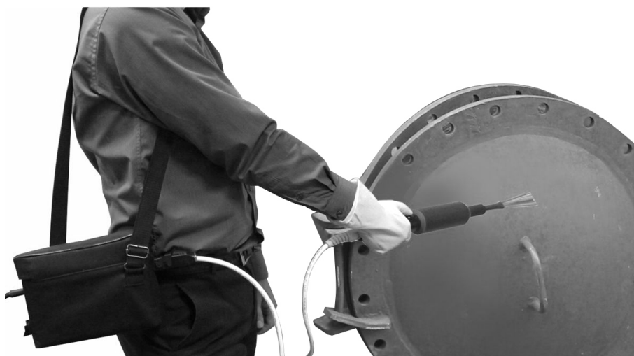
Рис. 21. Положение прибора при проведении контроля
