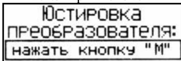
Нажатием клавиши «М» выполнить юстировку преобразователя. Дисплей при этом примет вид:
