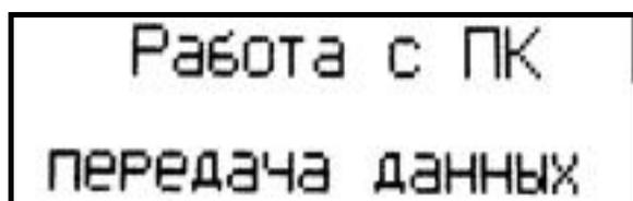
Перевести измеритель в режим передачи данных из архива измерителя в ПК, для чего, нажатием клавиши **РЕЖИМ** перевести измеритель в основное меню (1), клавишами «↑, ↓» переместить мигающее поле на пункт «**ПК**» и нажатием клавиши **ВВОД** активировать режим.
