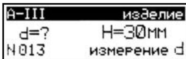
Для изменения значений класса арматуры, типа изделия и защитного слоя «**H**», необходимо нажатием клавиши **ВВОД** активировать мигание класса арматуры, затем, клавишами «**↑, ↓**» и **ВВОД** установить требуемый класс (например А-III), тип изделия и величину защитного слоя бетона.
