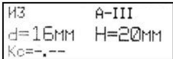
При необходимости изменения номера ячейки и класса арматуры нажать клавишу «**d/H**», активировав мигание номера ячейки, клавишами
