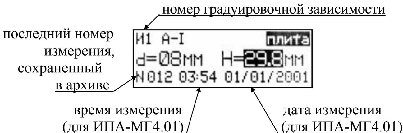
Результаты измерений высвечиваются в инверсном виде (на черном фоне). В данном случае видно, что проводились измерения защитного слоя  $H = 29,8$  мм, тип изделия – «плита», зависимость И1. Время и дата измерений отображаются только у мод. ИПА-МГ4.01.
