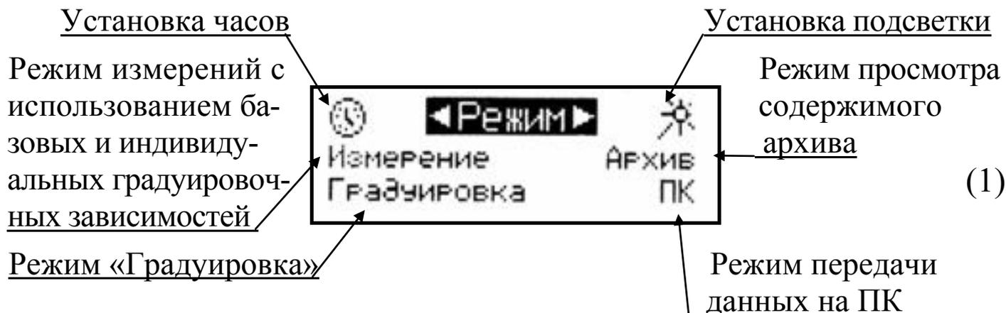
Измеритель модификации ИПА-МГ4 обеспечивает три рабочих режима:
