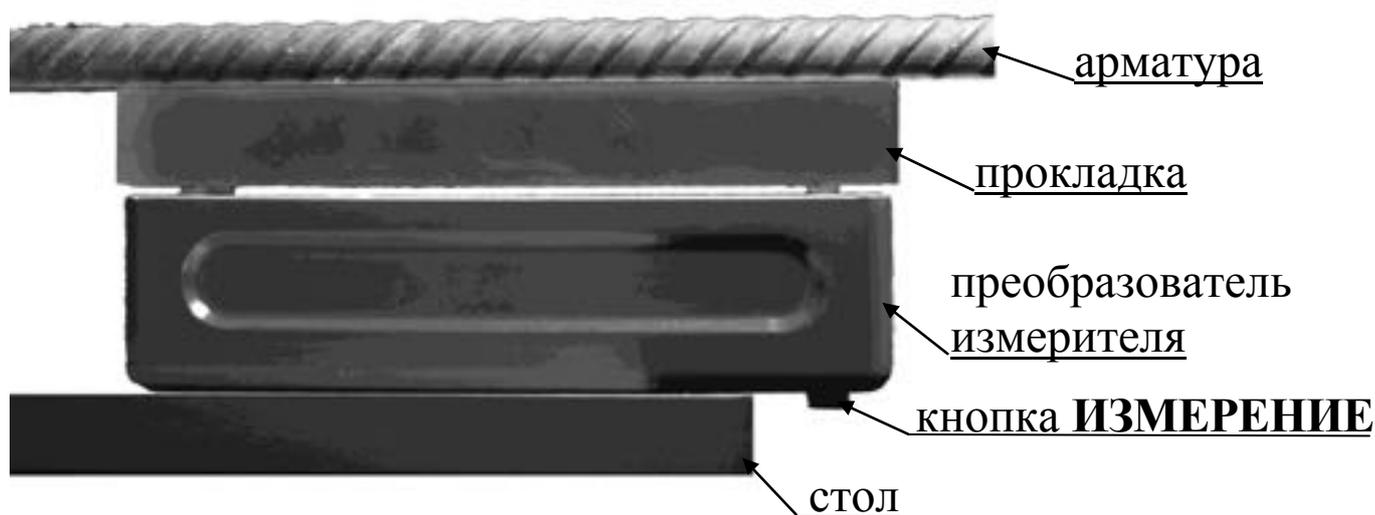
Рисунок 2 – Схема установки для испытания арматуры
