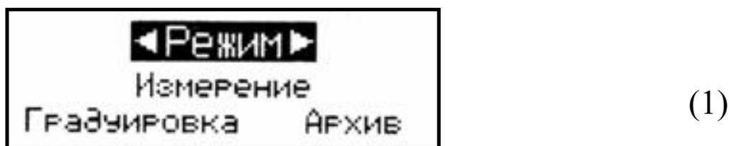
1.4.6.1 При включении питания измеритель находится в режиме «Измерение», в данном режиме осуществляется измерение толщины защитного слоя бетона с использованием базовых градуировочных зависимостей, установленных путем градуировочных испытаний горячекатаной арматуры классов, А-I (сталь марки Ст3), А-III (сталь марки 35ГС и 25Г2С) и проволоки из низкоуглеродистой стали холодноотянутой класса Вр-I, а также индивидуальных зависимостей, установленных пользователем.
