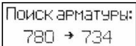
– вид дисплея при фиксации минимального цифрового кода в правой его части.
