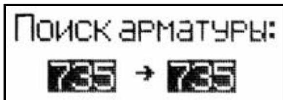
– вид дисплея в момент совпадения оси преобразователя с осью арматурного стержня (цифровые коды совпали).
