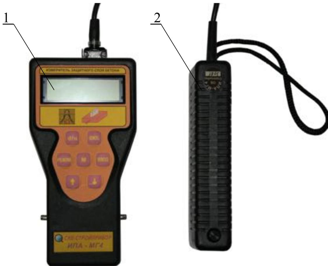
1 – электронный блок; 2 – преобразователь
