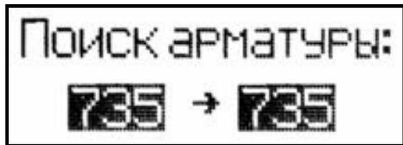
– вид дисплея в момент совпадения оси преобразователя с осью арматурного стержня (цифровые коды совпали).
