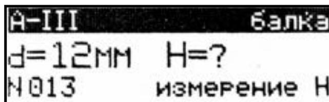
На дисплей выводятся установки, используемые при предыдущем включении измерителя.
