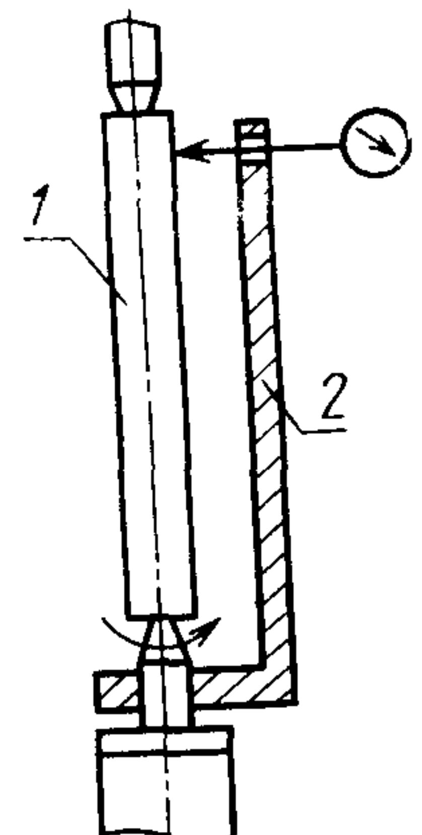
1—цилиндрическая оправка; 2—специальная державка
