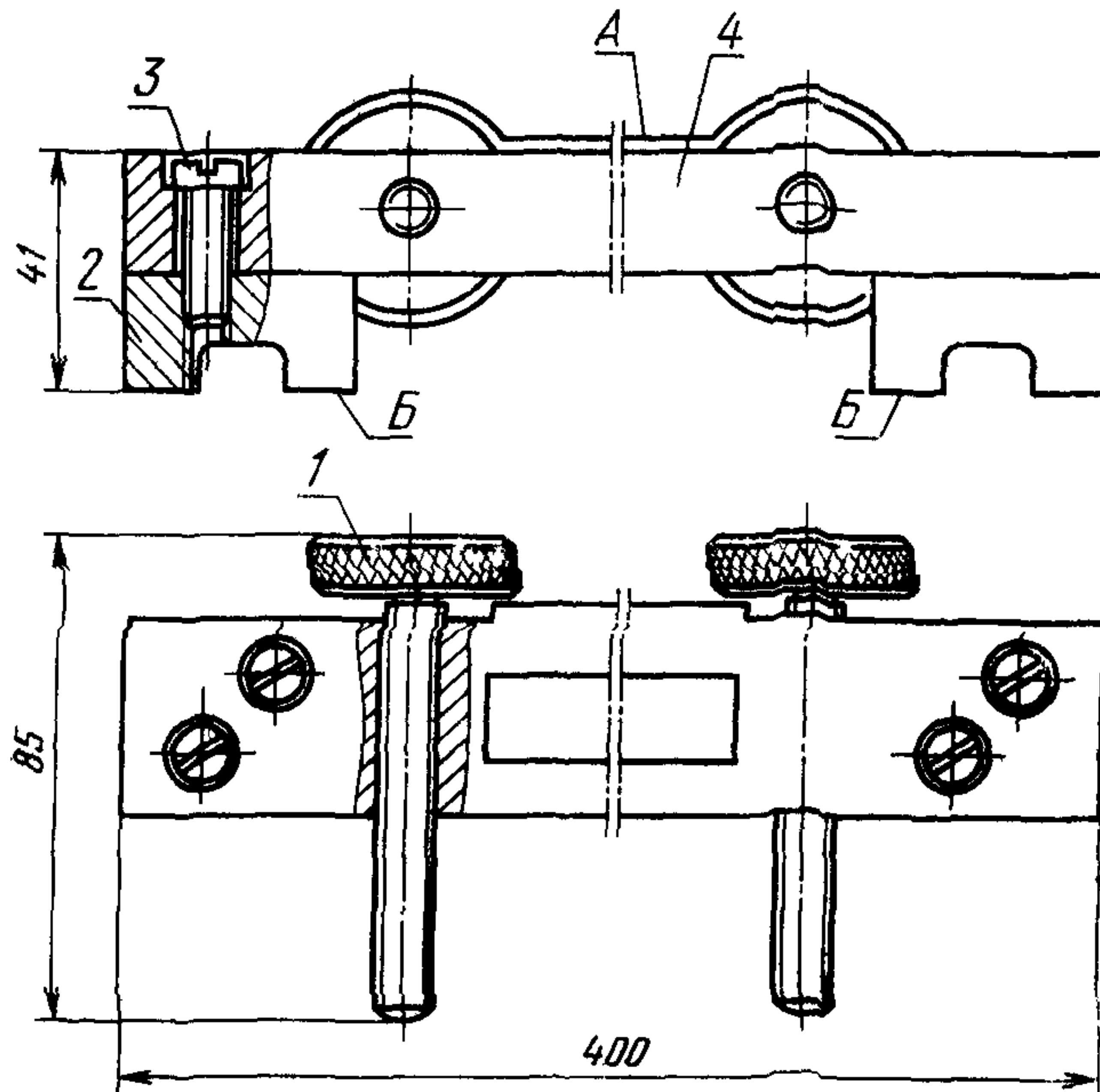
1—специальный винт; 2—сухарь; 3—винт М8×35
