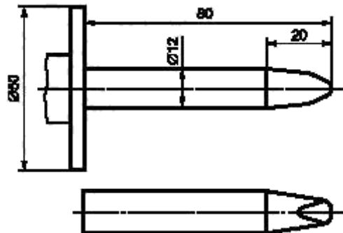
Рисунок В.1 — Жесткий испытательный палец
