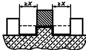
Пример 7 — Траектория включает в себя несцементированный стык с пазом с одной стороны, меньшим  $X$ , и с пазом другой стороны, равным или большим ширины  $X$ . Зазор и путь утечки соответствуют рисунку.
