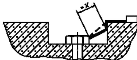
**Пример 10 —** Достаточно широкий просвет между головкой винта и стенкой углубления должен быть учтен. Путь утечки измеряют от винта до стенки, если это расстояние равно X.
