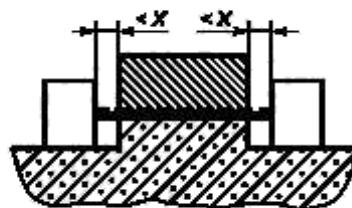
Пример 6 — Траектория включает в себя несцементированный стык с пазами, равными или большими  $X$ . Зазором является расстояние «прицельной прямой». Путь утечки повторяет контур пазов.
