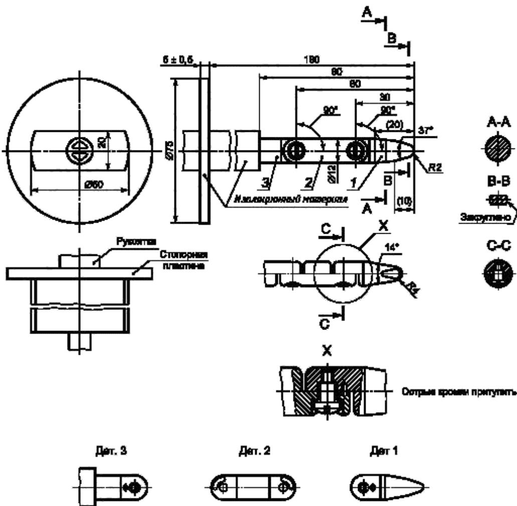
Рисунок В.2 — Шарнирный испытательный палец (испытательный щуп по стандартам государств)
