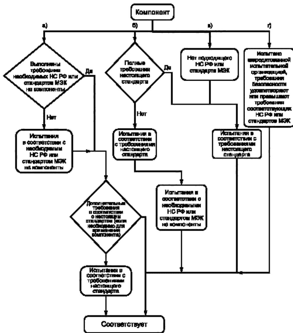
Рисунок 10 — Блок-схема для вариантов соответствия по 14.1, перечисления а), б), е) и г)
