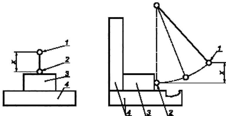
1 – начальное положение шара; 2 – положение шара во время удара; 3 – испытуемый образец;
