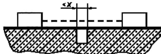
Рисунок С.1 — Примеры методов измерения зазоров и путей утечки, лист 1
