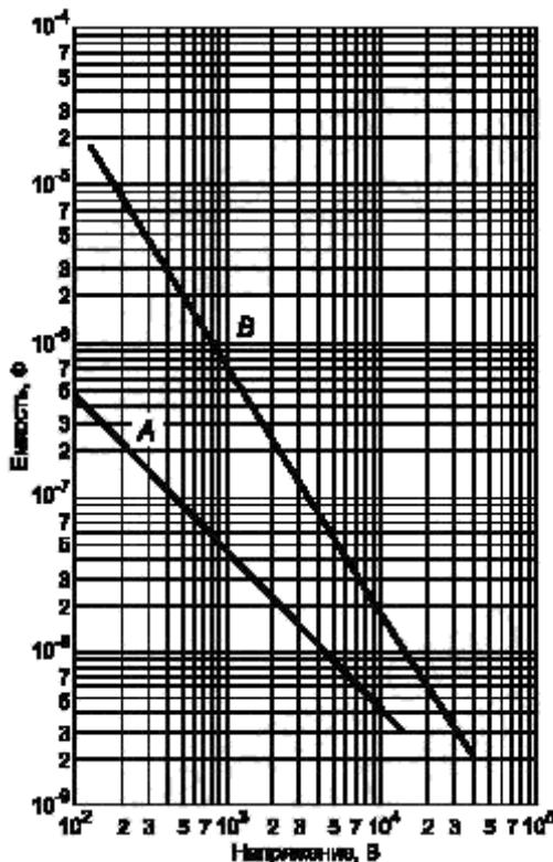
Рисунок 2 — Уровень емкости в нормальных условиях и условиях единичной неисправности
