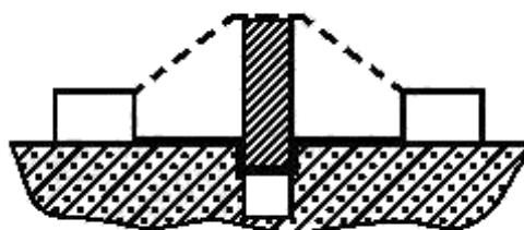
**Пример 9 —** Просвет между головкой винта и стенкой углубления слишком мал, чтобы принять его во внимание.
