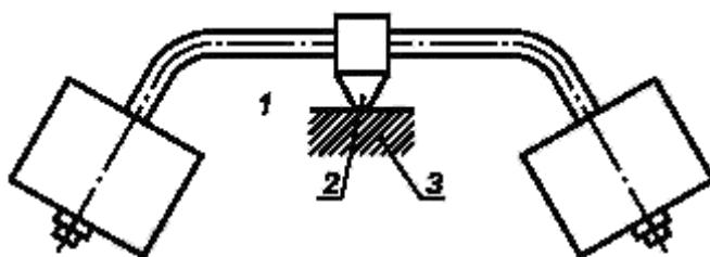
1 — испытуемая часть; 2 — сферическая часть устройства; 3 — опора
