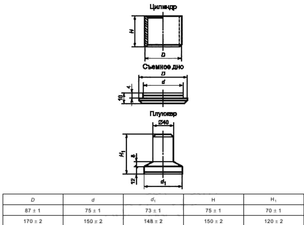
Рисунок 1 — Конструкция цилиндра и плунжера
