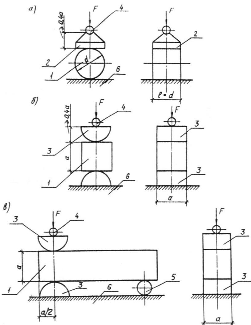
1 - образец; 2 - нагруженное устройство (плита) при испытании цилиндра;
