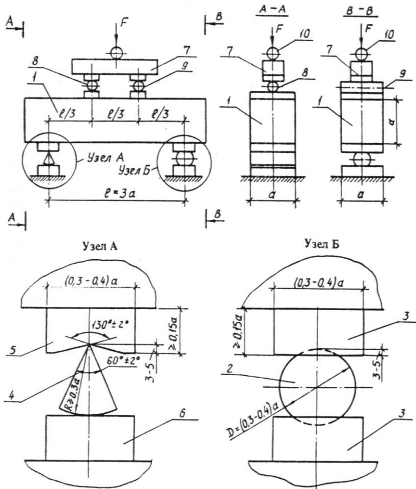
1 - образец; 2 - шар; 3 - опорная подушка; 4 - качающаяся призма; 5 - опорная сегментная подушка; 6 - опорная плоская подушка;
