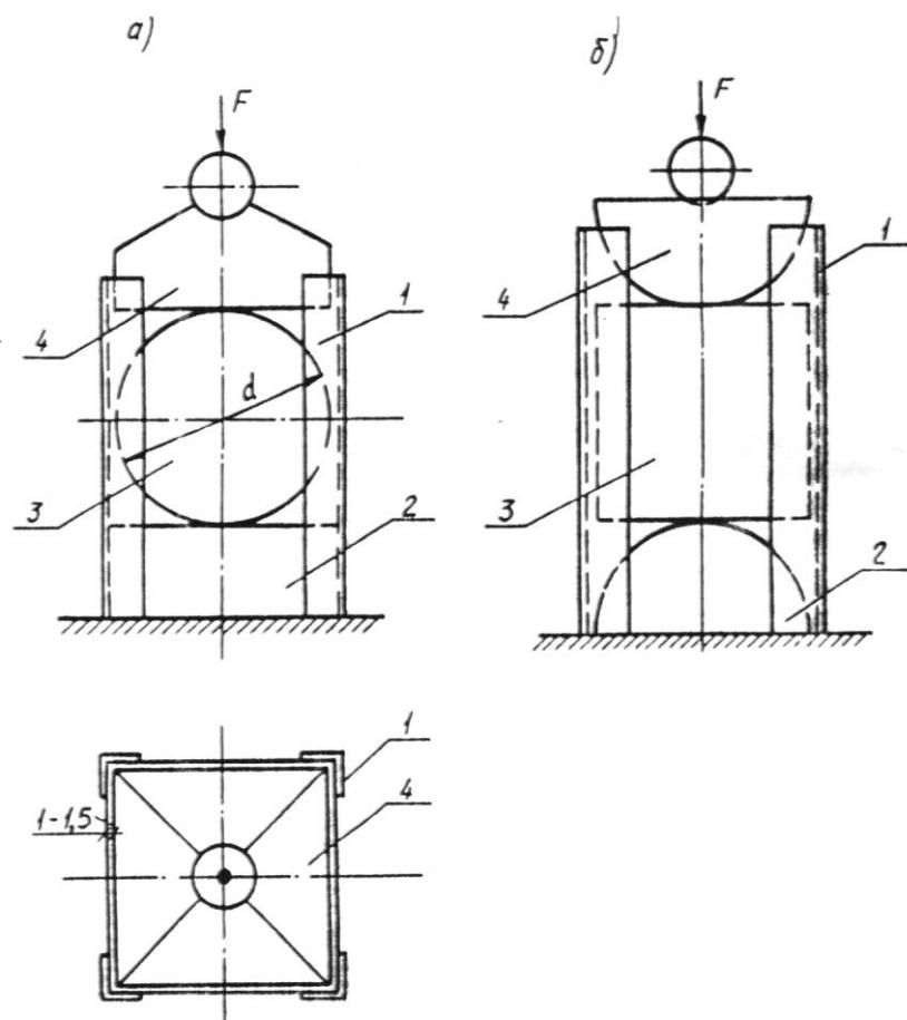
1 - направляющие; 2 - нижнее нагружочное устройство; 3 - образец; 4 - верхнее нагружочное устройство
