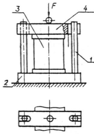
1 - направляющие; 2 - нижнее нагружочное устройство; 3 - образец; 4 - верхнее нагружочное устройство
