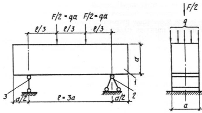
1 - образец; 2 - шарнирно неподвижная опора; 3 - шарнирно подвижная опора
