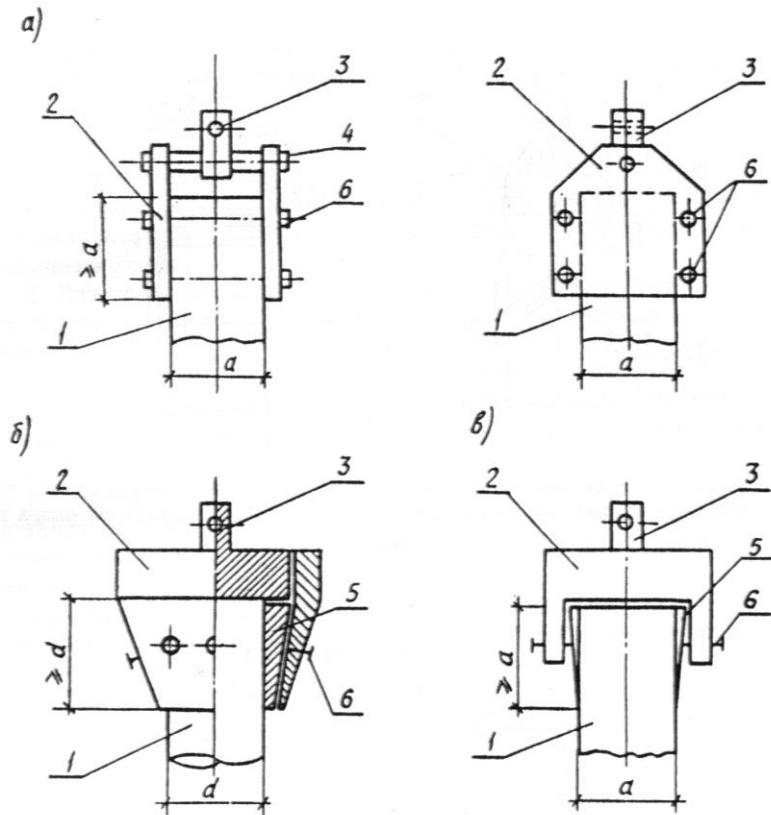
1 — образец; 2 - захват; 3 — концевой элемент шарнира Гука; 4 — ось; 5 — цанг; 6 - стягивающие винты
