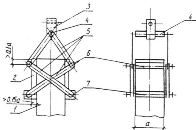
1 - образец; 2 - прижимная пластина; 3 - концевой элемент шарнира Гука; 4 - ось;
