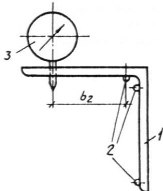
1 - корпус (угольник); 2 - опора; 3 - индикатор;  $b_2$  - база прибора
