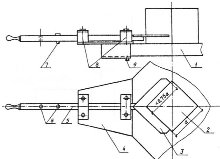
1 - плита пресса; 2 - бетонный образец; 3 - угольник; 4 - основание приспособления;
