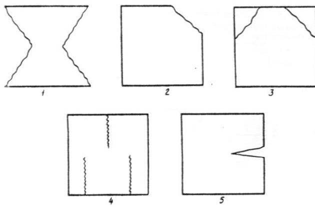
1 - нормальное разрушение; 2-5 - дефектные разрушения
