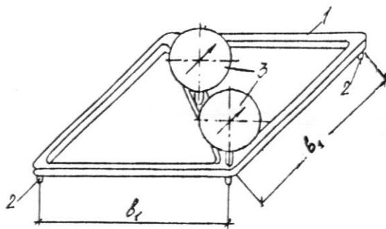
I - корпус (рамка); 2 - опора; 3 - индикатор; b<sub>1</sub> - база прибора
