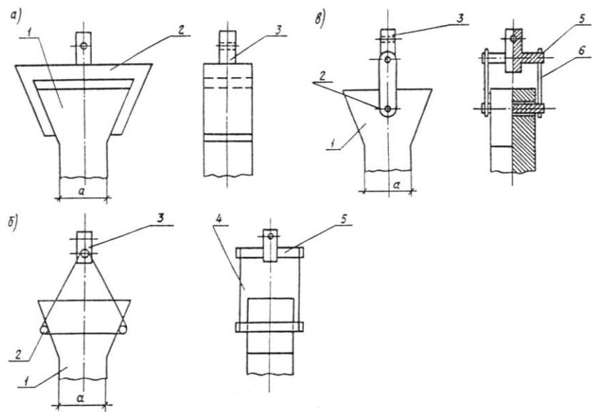
1 - образец; 2 - захват; 3 - концевой элемент шарнира Гука; 4 - гибкая тяга; 5 ~ ось;
