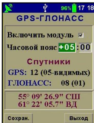
После активации модуля в строке статуса появится соответствующий значок в виде антенны красного цвета (верхний левый угол дисплея). После установления связи со спутниками цвет значка изменится на зеленый и произойдет автоматическая синхронизация времени на приборе. Для корректного отображения времени на дисплее необходимо правильно указывать часовой пояс.
