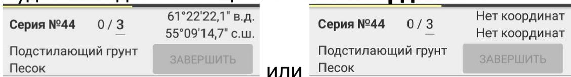
После того, как будет произведен сброс груза, беспроводной модуль начнет передавать данные на смартфон. Этот процесс длится примерно 2-3 секунды, и в течение этого времени новые удары фиксироваться не будут. Чтобы произвести следующий замер, необходимо дождаться сообщения «**Сброс груза**», обозначающий, что прибор готов к следующему измерению.
