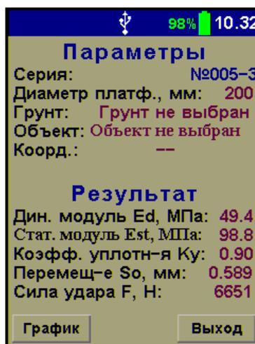
В данном режиме прибор позволяет просмотреть определенные в ходе эксперимента значения динамического модуля упругости **Ed**, статического модуля упругости **Est**, коэффициента уплотнения **Ku** (если введены коэффициенты градуировочной зависимости), виброперемещения штампа **S**, и силы удара **F**.
