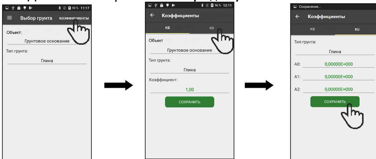
Коэффициенты «**KE**», «**KU**» устанавливаются для каждого сочетания объекта и типа грунта индивидуально.
