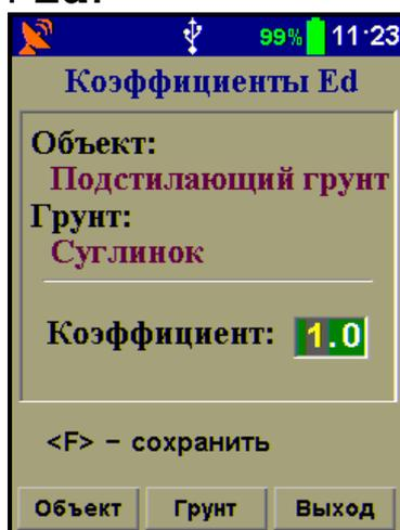
Коэффициент **k** устанавливается для каждого сочетания объекта и типа грунта индивидуально.
