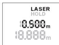
Lai no jauna ieslēgtu läzeru, vēlreiz nospiediet mēriņuma rezultāta fiksēšanas taustiņu „HOLD“ **2**. Uz displeja sāk mirgot läzera ieslēgšanas indikators **LASER**. Displeja augšējā rindā tiek parādīts iepriekšējā mēriņuma rezultāts. Displeja apakšējā rindā tiek parādīts aktuālais mēriņanas rezultāts, kas tiek periodiski atjaunots.
