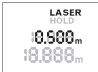
Wciśnąć przycisk „HOLD“ **2**, aby ponownie włączyć laser. Wskaźnik **LASER** migra na wyświetlaczu. W górnym pasku wyświetlana jest poprzednia wartość pomiarowa. W dolnym pasku wyświetlana jest aktualna/aktualizowana wartość pomiarowa.
