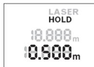
Өлшеу әдісін тоқтату үшін „HOLD“ түймесін басыңыз **2**. Лазер өшіп дисплейде **HOLD** индикаторы жаңады. Ағымдық өлшеу көлемі дисплейдің төмөн қатарында көрсетіледі, бірақ жаңартылмайды.
