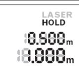
Mõõtmise peatamiseks vajutage „HOLD“-nupule **2**. Laserkiir lülitub välja ja näit **HOLD** ilmub ekraanile. Aktuaalset mõõtetulemust kuvatakse endiselt ekraani alumisel real, kuid seda ei ajakohastata pidevalt.
