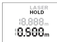
Lai apturētu mēriņanas procesu, nospiediet mēriņuma rezultāta fiksēšanas taustiņu „HOLD“ **2**. Pie tam izslēdzas läzera stars, un uz displeja parādās mēriņuma rezultāta fiksēšanas indikators **HOLD**. Displeja apakšējā rindā joprojām ir redzams aktuālais mēriņanas rezultāts, taču tas vairs nemainās, jo netiek periodiski atjaunots.
