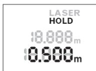
A mérési eljárás leállításához nyomja meg a **2 „HOLD”** gombot. A lézersugár kikapcsolásra kerül és a kijelzőn megjelenik a **HOLD** kijelzés. Az aktuális mérési eredmény továbbra is a kijelző legalsó sorában jelenik meg, de már nem kerül folytonosan frissítésre.
