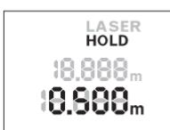
Če želite merjenje začasno prekiniti, pritisnite tipko „**HOLD**“ **2**. Laserski žarek se izključi in na prikazovalniku se prikaže **HOLD**. Trenutna izmerjena vrednost je še naprej prikazana v spodnji vrstici prikazovalnika, vendar se več ne posodablja.
