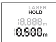
Wciśnąć przycisk „HOLD“ **2**, aby zatrzymać pomiar. Wiązka laserowa jest wyłączana, a wskaźnik **HOLD** pojawia się na wyświetlaczu. Aktualna wartość pomiarowa wyświetlana jest w dalszym ciągu w dolnym pasku wyświetlacza, ale nie jest stale aktualizowana.
