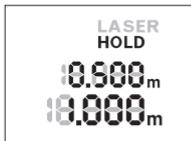
Apăsați tasta „HOLD“ **2** pentru blocarea procesului de măsurare. Raza laser se deconectează iar pe display apare indicatorul **HOLD**. Valoarea curentă măsurată va continua să fie afișată pe rândul de jos al displayului, dar nu va mai fi actualizată continuu.
