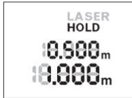
Wciśnąć przycisk „HOLD“ **2** po raz wtóry, aby ponownie zatrzymać pomiar. Wiązka laserowa jest wyłączana, a wskaźnik **HOLD** pojawia się na wyświetlaczu. W górnym pasku wyświetlana jest poprzednia wartość pomiarowa. W dolnym pasku wyświetlana jest aktualna wartość pomiarowa, ale nie jest ona stale aktualizowana.
