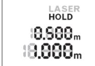
Знову натисніть на кнопку «HOLD» **2**, щоб ще раз зупинити вимірювання. Лазерний промінь вимикається, і на дисплей з'являється надпис **HOLD**. У верхньому рядку відображається попередній результат вимірювання. В нижньому рядку дисплея відображається, але більше не актуалізується актуальній результат вимірювання.
