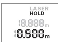
Stisknutím tlačítka „HOLD“ **2** zastavíte měření. Laserový paprsek se vypne a na displeji se zobrazí **HOLD**. Ve spodním rádku na displeji se následně zobrazuje aktuální naměřená hodnota, která se již neaktualizuje.
