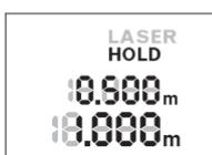
Нажмите на кнопку «HOLD» **2**, чтобы остановить измерение. Лазерный луч выключается, и на дисплее отображается **HOLD**. Актуальный результат измерения по-прежнему отображается в нижней строке дисплея, но не актуализируется постоянно.
