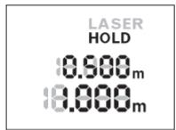
Pritisnite ponovno tipku „HOLD“ **2** kako biste ponovno zaustavili mjerjenje. Laserska zraka se isključuje i pokazatelj **HOLD** se pojavljuje na displeju. U gornjem retku se prikazuje pretvodna mjerena vrijednost. U donjem retku se prikazuje aktualna mjerna vrijednost ali se više stalno ne aktualizira.
