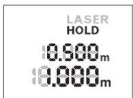
Opakovaným stisknutím tlačítka „HOLD“ **2** znovu zapněte laser. Na displeji bliká nápis **LASER**. V horním řádku se zobrazí předchozí naměřená hodnota. Ve spodním řádku na displeji se nepřetržitě zobrazuje aktualizovaná/aktuální naměřená hodnota.
