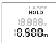
Натисніть на кнопку «HOLD» **2**, щоб зупинити вимірювання. Лазерний промінь зупиняється, і на дисплеї з'являється надпис **HOLD**. Актуальний результат вимірювання продовжує відображатися в нижньому рядку дисплея, але більше не актуалізується.
