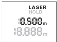
Pritisnite ponovno tipku „HOLD“ **2** za ponovno uključivanje lasera. Pokazatelj **LASER** treperi na displeju. U gornjem retku se prikazuje pretvodna mjerena vrijednost. U donjem retku se stalno prikazuje aktualizirana/aktualna mjerna vrijednost.
