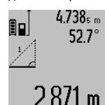
По окончании измерения результат для искомого отрезка «**X**» отображается в строке результата **c**. Значения измерения для отрезка «**1**» и угла «**a**» отображаются в строках измеренных значений **a**.
