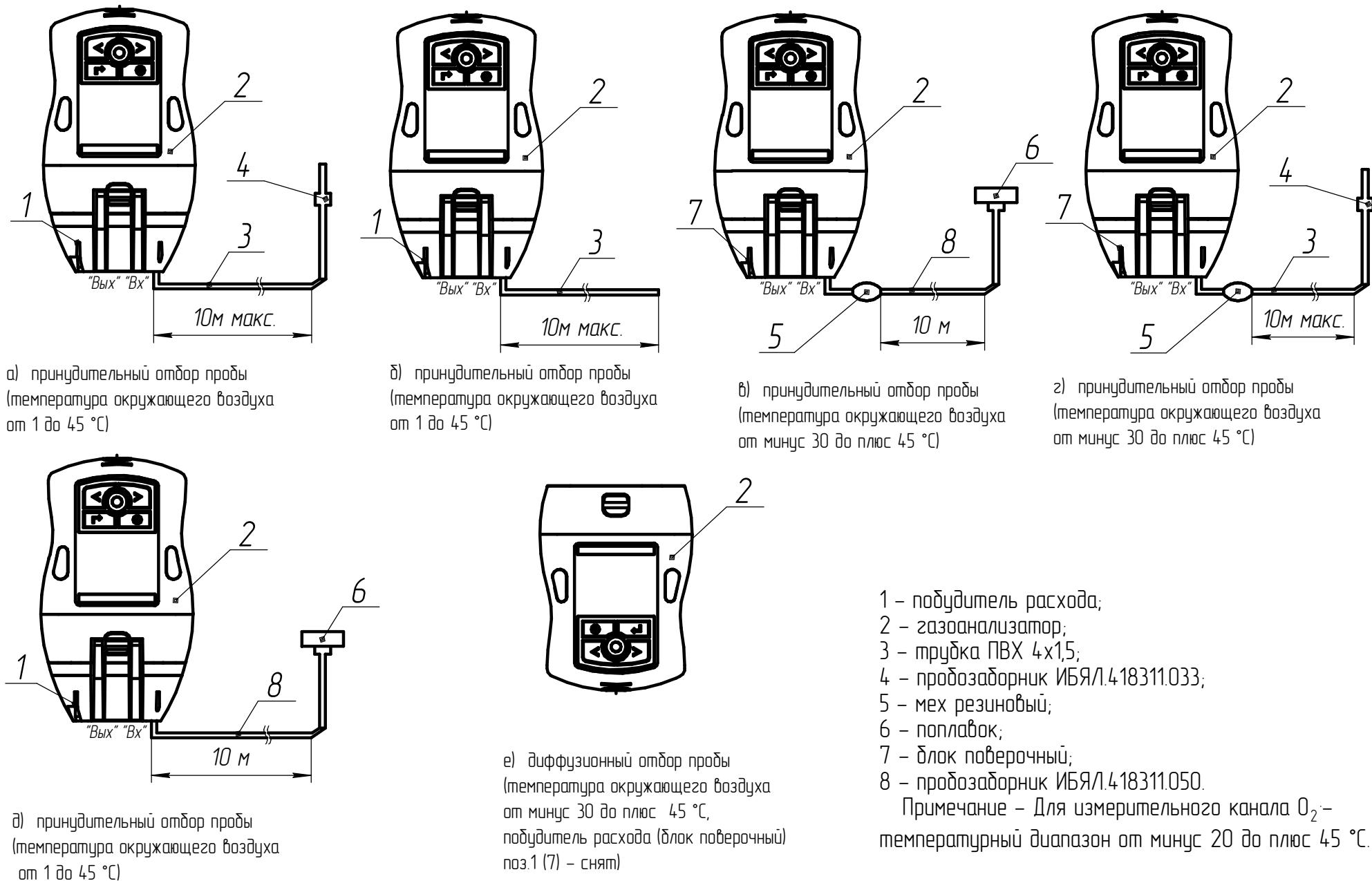
Рисунок 2.2 – Газоанализаторы АНКАТ-7664Микро ... -16. Способы отбора пробы
