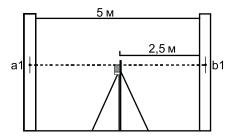
Установить лазерный построитель плоскостей на расстоянии 0,5-0,7м от стены и нанести, как указано выше, те же отметки. Если разности {a1-a2} и {b1-b2} не отличаются друг от друга более чем на величину "точность", заявленную в технических характеристиках, точность Вашего лазерного построителя в допустимых пределах.
